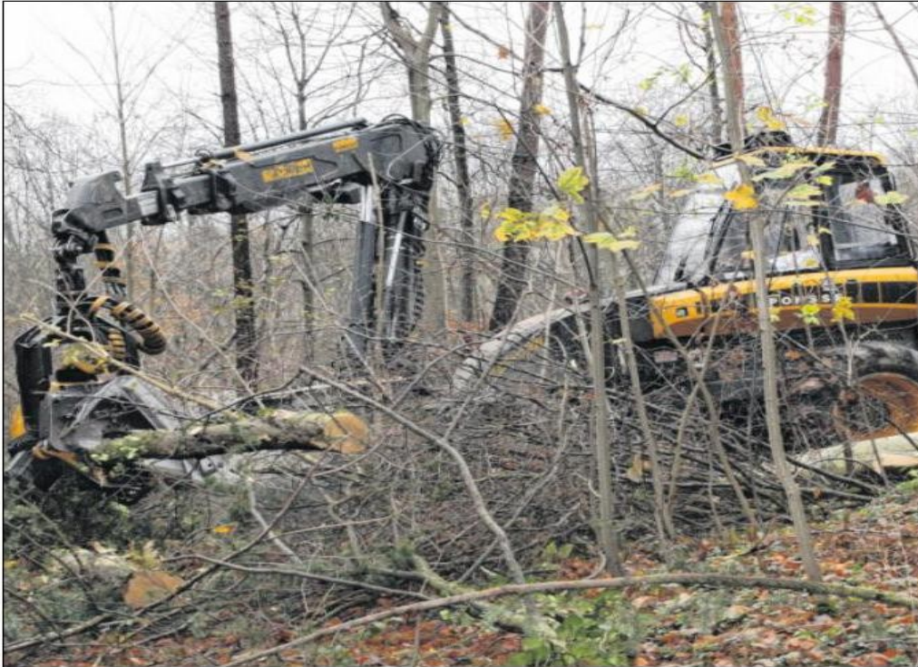
DIE STEUERUNG IM COCKPIT des Harvesters unterstützt die Holzernte bei der Rodung an der Autobahn. 15 Festmeter schafft die Maschine pro Stunde. Foto: Lothar
