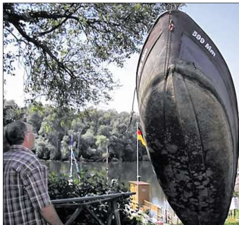
VOM ROST VERURSACHTE LÖCHER fanden sich im Rumpf des Fähren-Beiboots, als die schwarze Bitumenschicht beim Sandstrahlen entfernt war.
